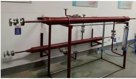
图 3 阀门气体泄漏实验平台
